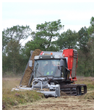
Dameuse munie d'un broyeur, d'une trémie et d'un bac de ramassage
