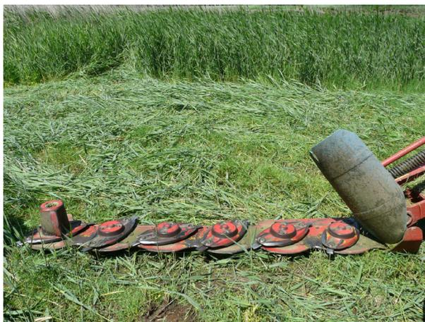
**La faucheuse à tambour** : comme sur l'outil précédent, le dispositif de coupe repose sur des couteaux qui s'écartent avec le mouvement rotatif des tambours suspendus, mouvement transmis par le haut. Comme précédemment, les faucheuses les plus fréquemment utilisées comptent entre 4 et 6 tambours.
