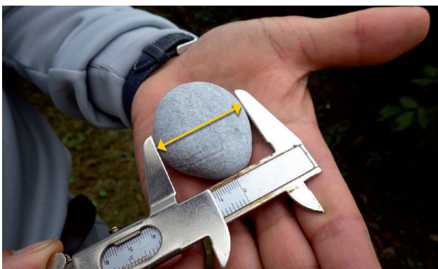
Figure 25 Mesure de la plus grande largeur perpendiculaire d’un caillou au pied à coulisse en suivant le protocole Wolman.
