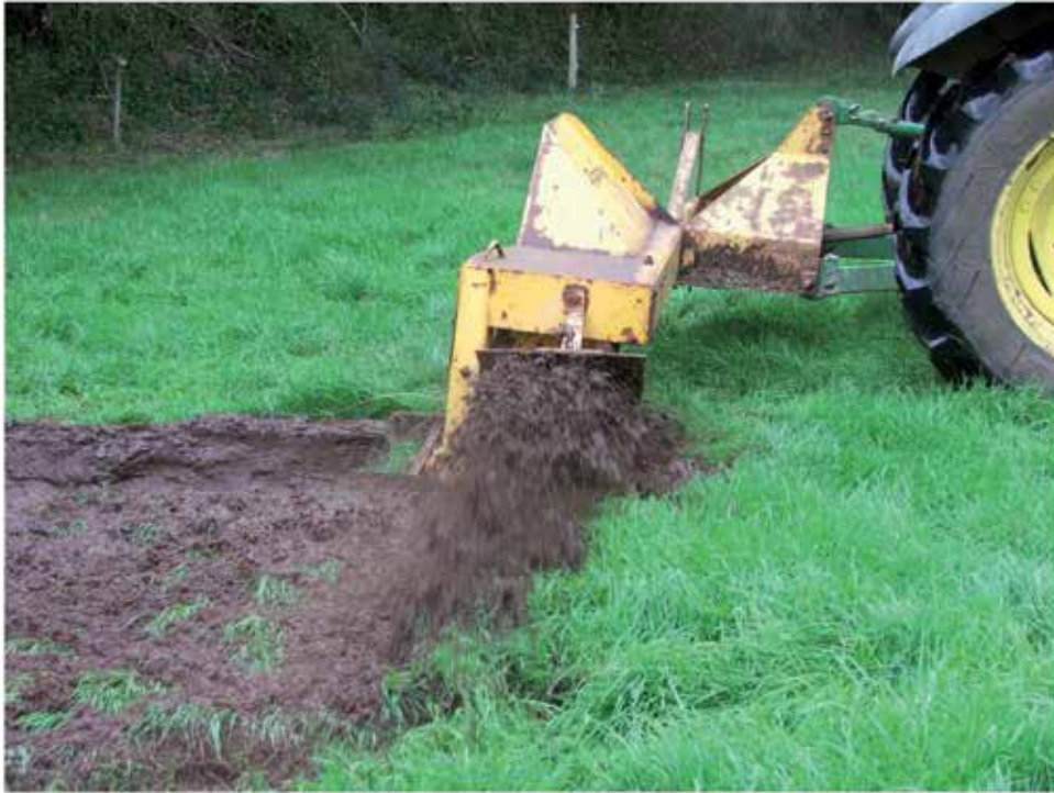
Rototrancheuse en action
